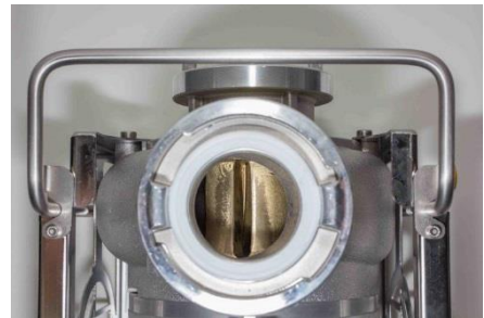
Bild 2.1: Reinigungsschlitz auf „12-Uhr-Position“
