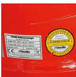
Test électrique selon la norme DIN
