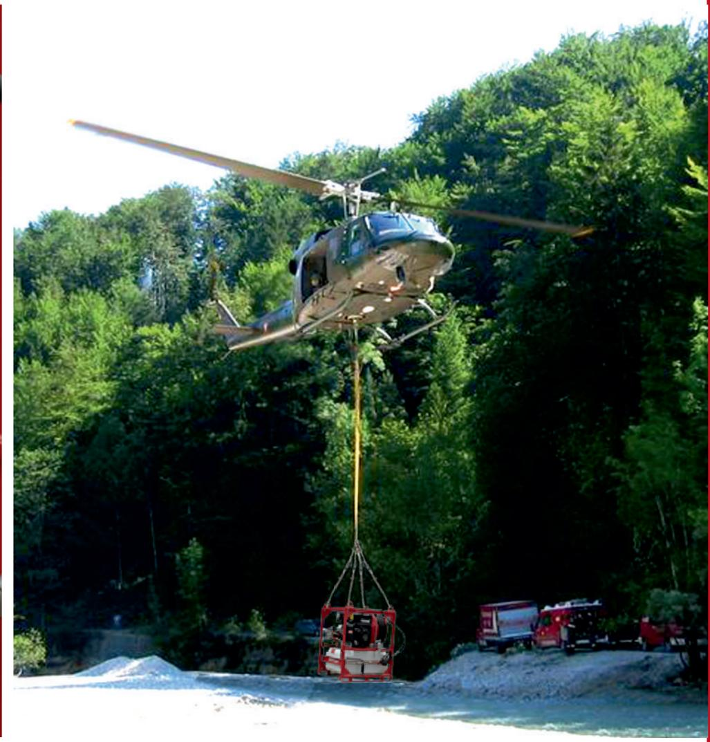
Flugtaugliche Hochdrucklöschanlage mit 820 Liter Zusatztank
