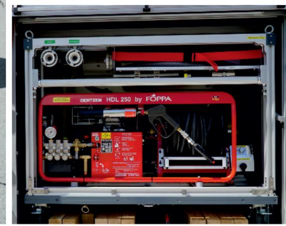
Bilder: Pumpiers Plav / HDL 250 Einbauversion ohne Tank, zusätzlich flugtauglicher IBC Container mit 600 Liter
