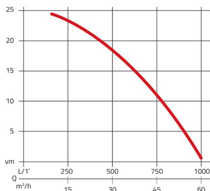
Das Diagramm zeigt Ihnen die Pumpleistung der Rössle Tauchpumpe TERA in m<sup>3</sup> pro Stunde in Relation zur Pumphöhe.
