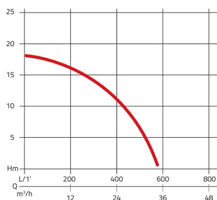
Das Diagramm zeigt Ihnen die Pumpleistung der Rössle Tauchpumpe C-ROSS in m³ pro Stunde in Relation zur Pumphöhe.
