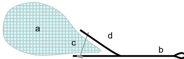
Sorbentsperre (a) von oben mit Gewebe über den Kunststoffnagel ( c ) ziehen und eindrücken, halten und den schmalem Schürzenstreifen (d) über den Nagel drücken..
