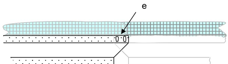
Prendre les barrages Sorbent / **SEABOR** tablier aquatique et les accoupler au moyen des raccords tournants (e). Les barrages peuvent s'accoupler par les œillets/crochets montés d'origine
