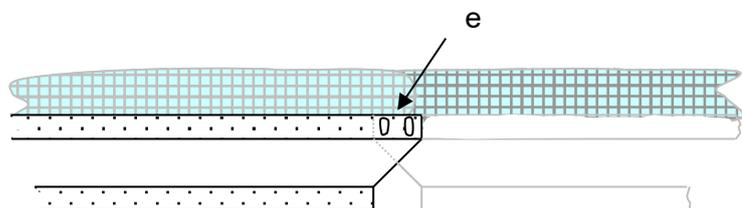
Sorbentsperre / **SEABOR** Wasserschürze mit weiteren Elementen verbinden mittels Oesen/Drehverschluss (e). Sorbentsperren können mit den angebauten Oesen/Haken miteinander verbunden werden.
