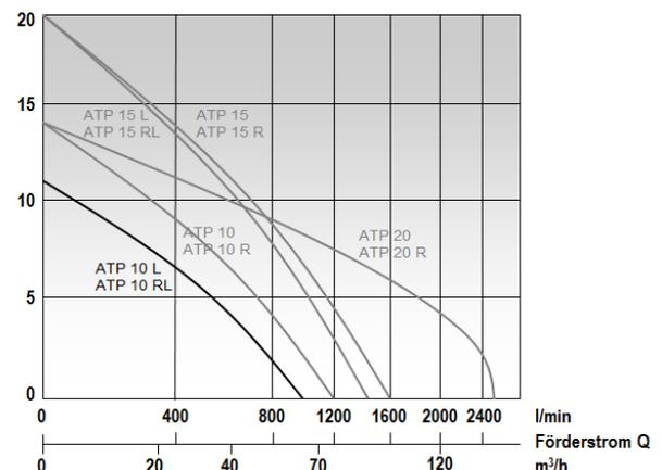
Q l/min, bei H m (Wassersäule), gültig für ρ = 1 kg/dm<sup>3</sup> und kinematische Viskosität η = 1 mm<sup>2</sup>/s. Förderwert- und Wirkungsgradgarantie nach DIN 1944, Genauigkeitsstufe III.
