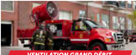
VENTILATION GRAND DÉBIT
