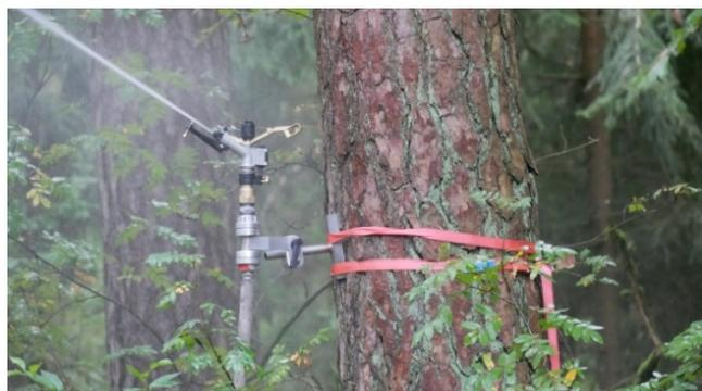
(stufenlos verstellbarer Baumhalter)
