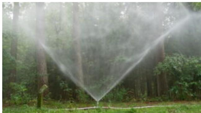
Neben der Besonderheit der erzeugten Wasserwand kommt hier auch die Tatsache des geringen Wasserverbrauchs zu Gute. Die spezielle Düse verbraucht ca. 130 l/m. Dieser ist um ein Vielfaches geringer als bei einem Hydroschild.
