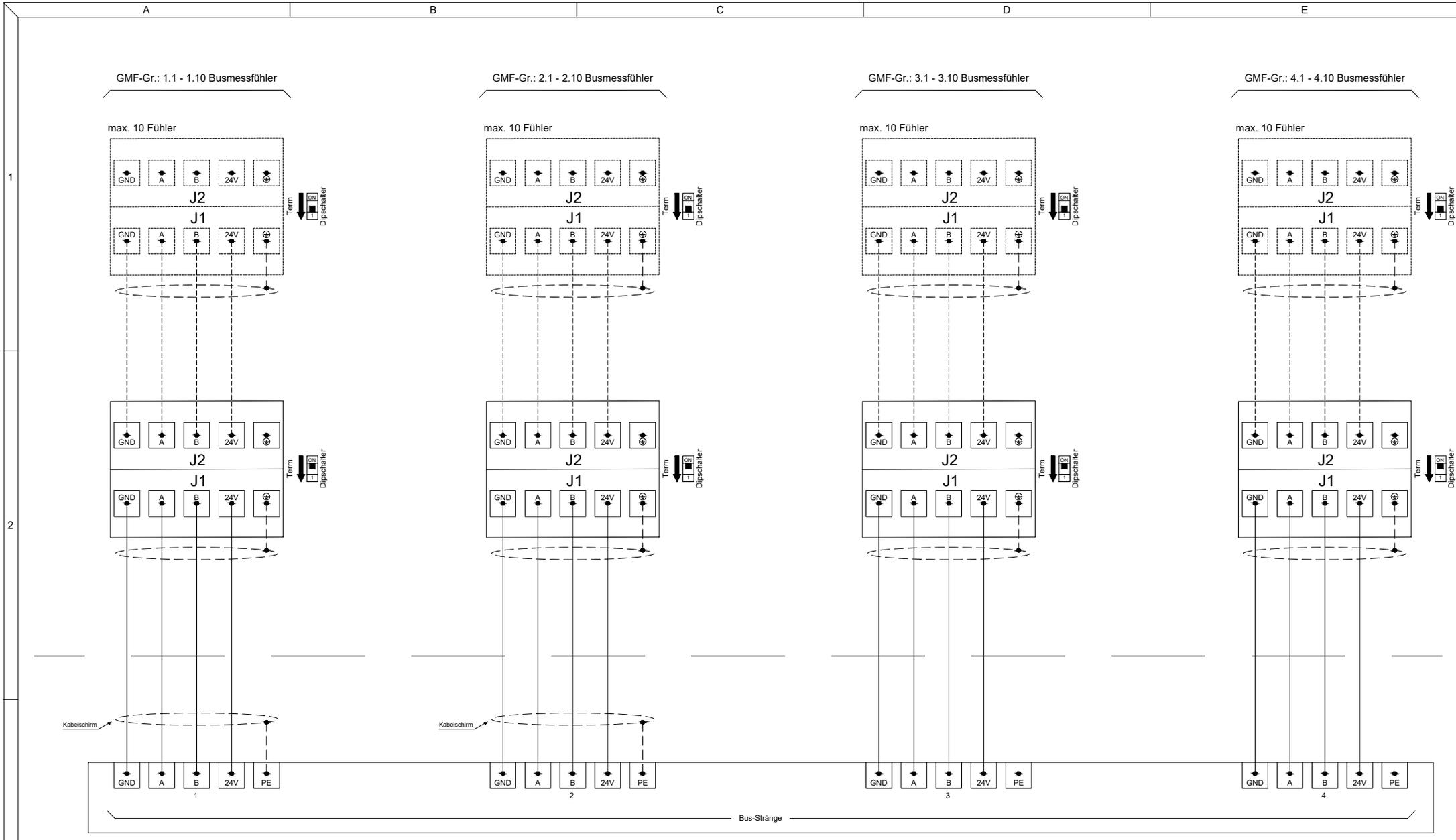
Der letzte Fühler im Busstrang muss zwingend terminiert werden. Dipschalter rechts im Fühler in Pfeilrichtung einstellen !!!
