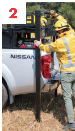
2 Chargement et déchargement Les pieds télescopiques permettent de l'élever pour le charger sur le véhicule ou le décharger.
