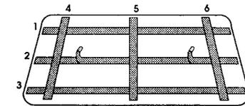
Kleben Sie vor dem Sägen des Glases das Band, wie oben abgebildet, auf die Scheibe. Lassen Sie zum schnellen Herausheben der Scheibe kurze Streifen als Griffe abstehen.
