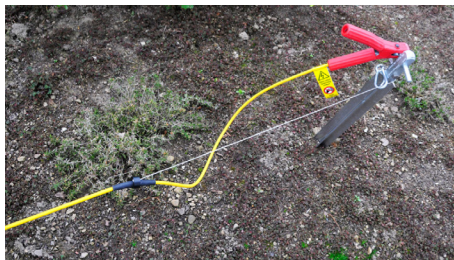
Mise à la terre avec un piquet de mise à la terre
