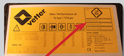
Vorschlag Prüffristen auf dem Typenschild
